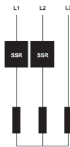
Relais statique biphasé pilotant des résistances de chauffe câblées en étoile (adapté uniquement à des charges basse tension équilibrées et sans le neutre).
